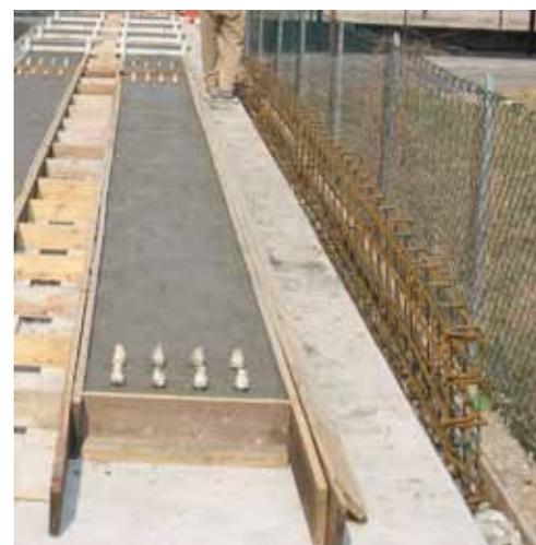
Figura 1 – Prove di campo sul ritiro contrastato in lastre appoggiate su terreno e bloccate alle estremità.
