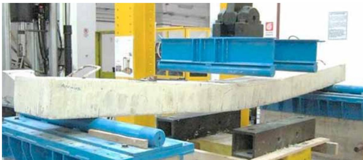
Un gruppo di esperti sta indagando la possibilità di impiegare nel rinforzo strutturale degli edifici una nuova classe di materiali compositi per l'ingegneria civile realizzati progettando matrici inorganiche innovative, note in letteratura col termine "geopolimeri".....
