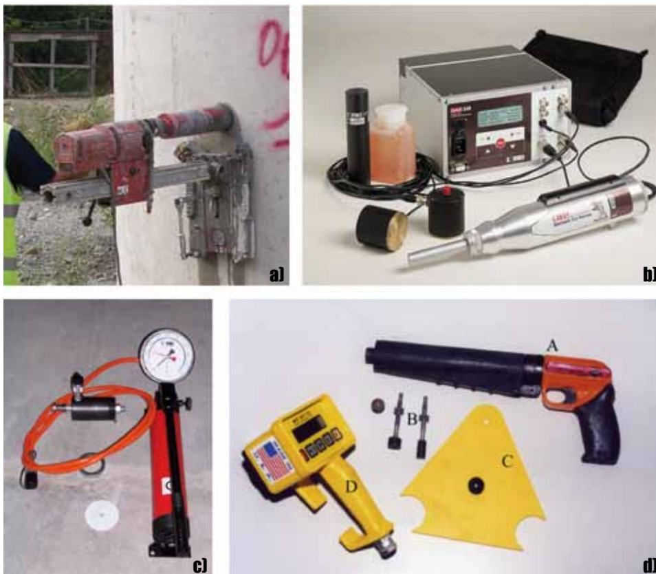
**Figura 1.** Strumenti per PD e PnD; a) Carotatrice; b) Sclerometro e Strumento ultrasonico; c) Estrazione di inserti (Pull-out); d) Resistenza alla penetrazione (sonda Windsor)
