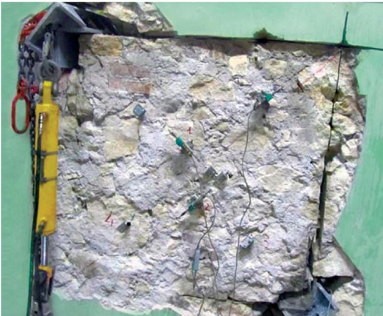
Fig. 05: Pannello murario a prova ultimata. Valore limite di rottura non raggiunto a causa del cedimento delle catene che collegavano i martinetti alle piastre.
