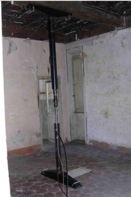
Applicazione del carico su solaio di calpestio in legno massiccio tramite cilindro oleodinamico
