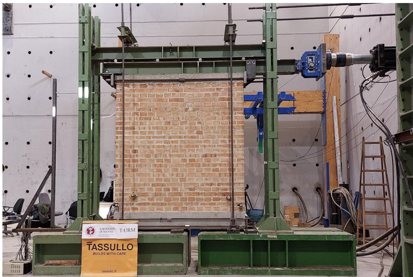
Figura 8. Prove in scala reale: setup di prova
