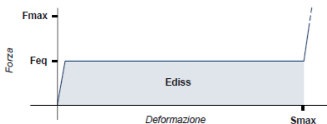
Grafico equivalente forza-deformazione e caratteristiche meccaniche di SismoShock
