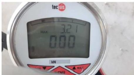
fig. 1 Raggiungimento del carico di trazione di 3,21 kN nella prova n.1
