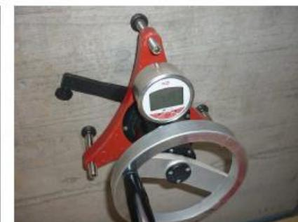
fig. 21 Raggiungimento del carico di trazione di 1,2 kN nella prova n.3
