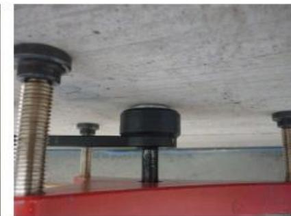
fig. 23 Condizione del fissaggio a 2,2 kN nella prova n.3
