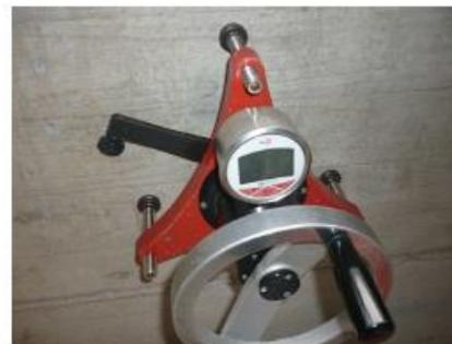
fig. 22 Raggiungimento del carico di trazione di 2,2 kN nella prova n.3
