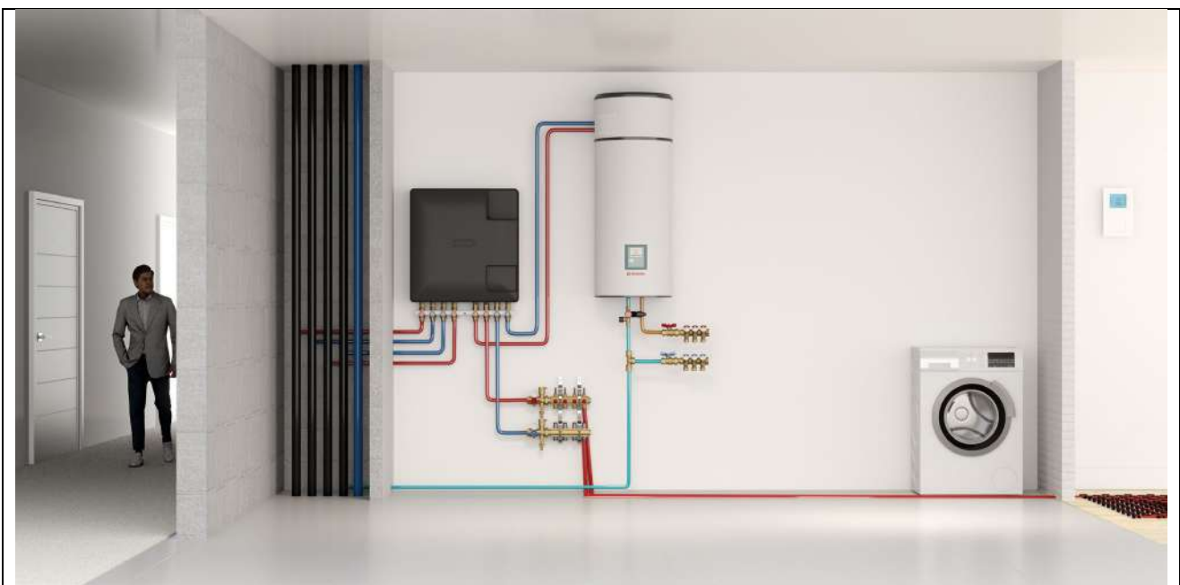
Fig.3 – Unità immobiliare con modulo idronico a 4 tubi per impianti radianti e produzione ACS con booster
