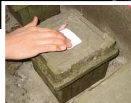
Inserimento dei Dispositivi RfId A sulla superficie superiore del provino di calcestruzzo e RfId B sulla cubettiera
