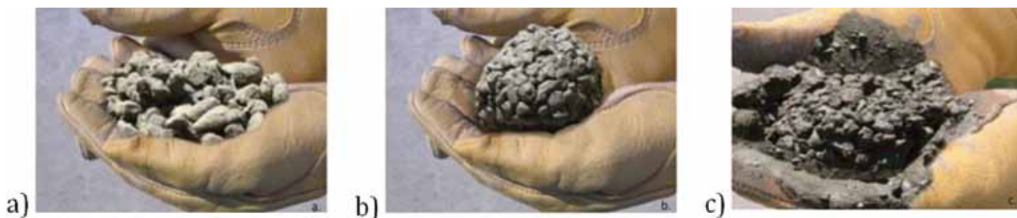
Figura 3. Miscela di calcestruzzo drenante in funzione del contenuto d'acqua: a) poca acqua; b) giusto contenuto; c) troppa acqua
