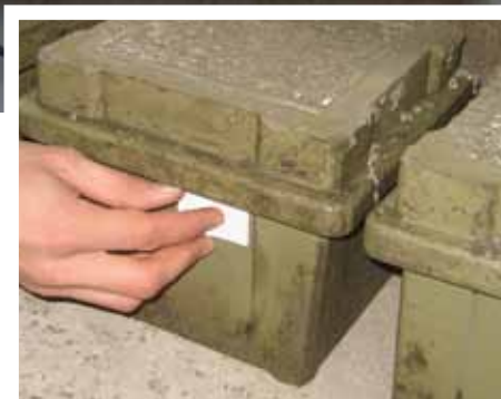
Inserimento dei Dispositivi RfId A sulla superficie superiore del provino di calcestruzzo e RfId B sulla cubettiera
