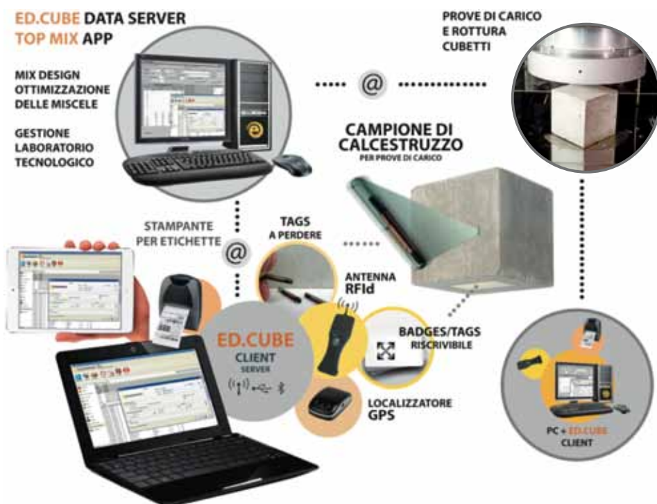
Layout di un tipico sistema informatizzato per la gestione e tracciabilità dei provini
