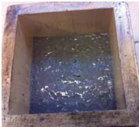
Micro Chip (TAG) immerso durante il confezionamento del provino
