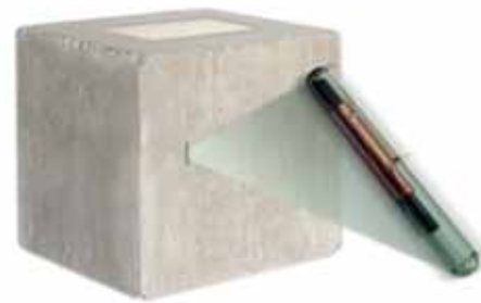
Provino con BADGE per riconoscimento e TAG per l'identificazione univoca a tecnologia RFID
