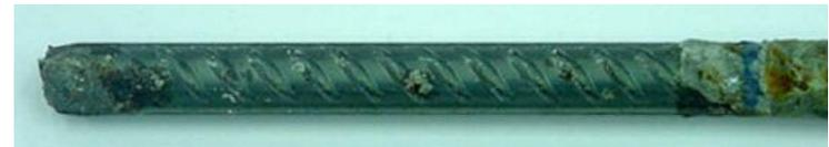
Barra con CNI ed una concentrazione del 2% di Cloruro
