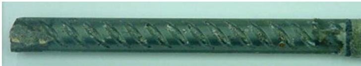
Barra con CN ed una concentrazione del 2% di Cloruro
