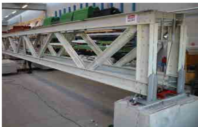
La passerella montata per le prove di carico
