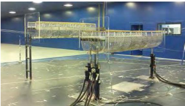
Prove in laboratorio e posizionamento previsto degli smorzatori elasto-viscosi e viscosi
