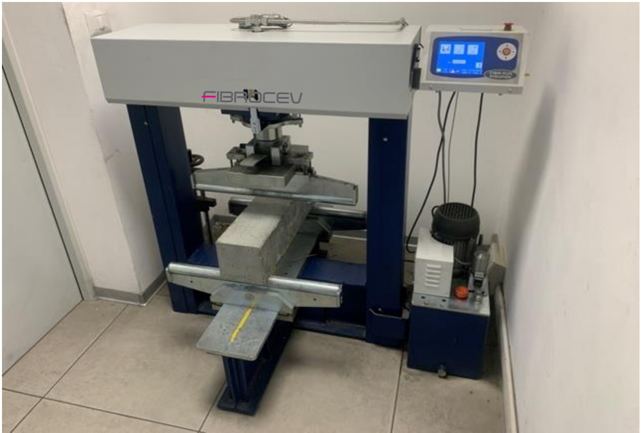
Figura 5. Set-Up prova di trazione per flessione secondo EN 14651
