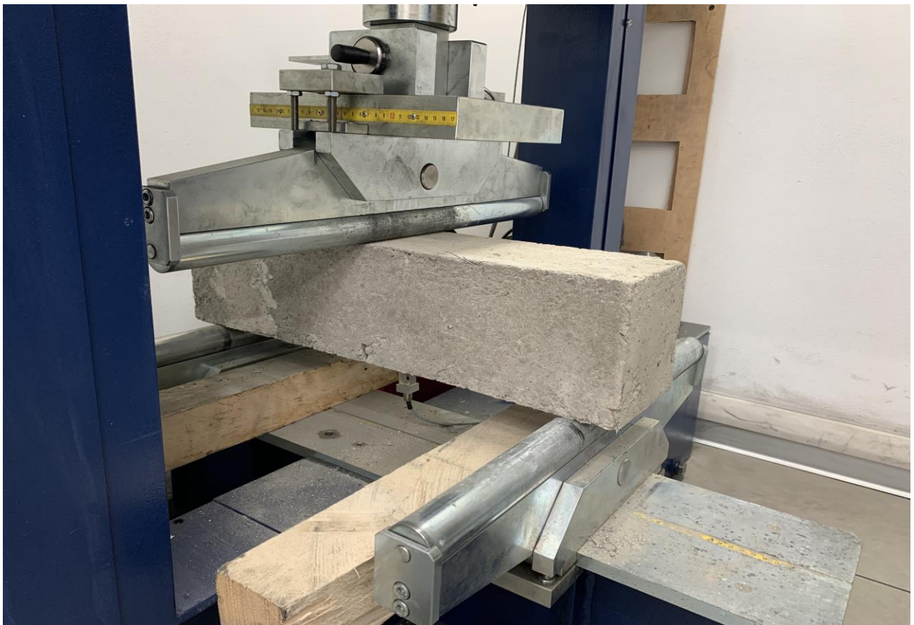
Figura 6. Set-Up prova di trazione per flessione secondo EN 14651
