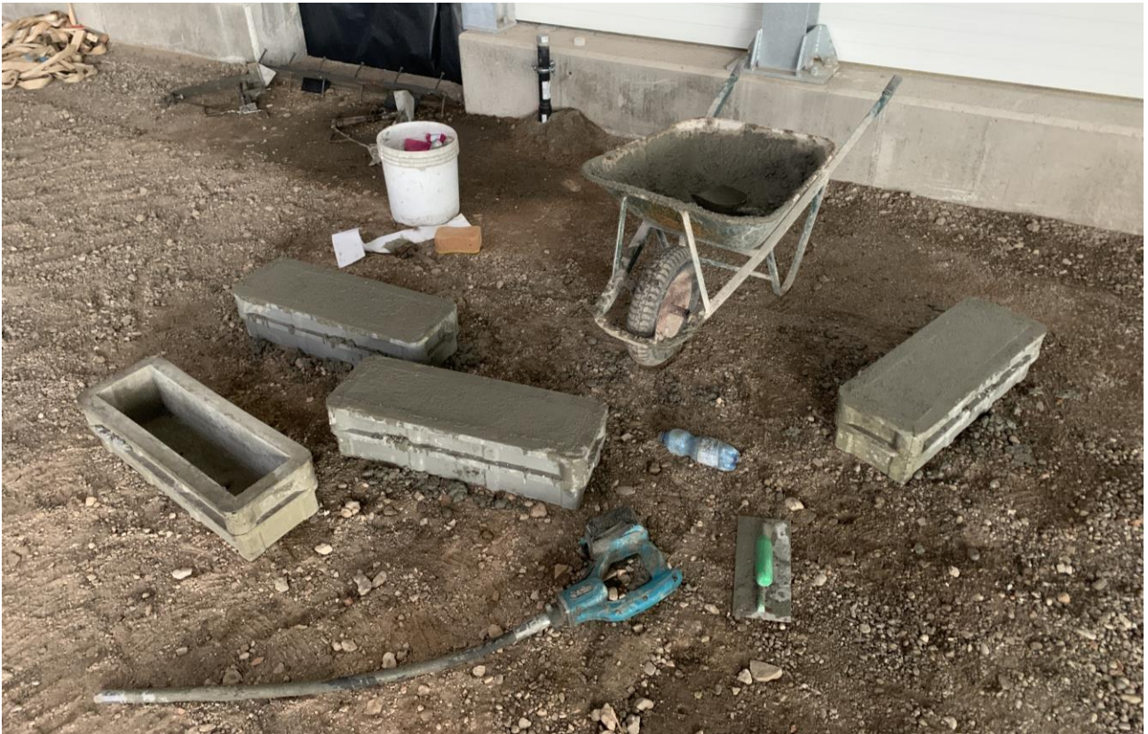
Figura 3. Prelievo di Fibrocev LAB dei campioni di FRC da sottoporre a prova di trazione per flessione secondo EN 14651
