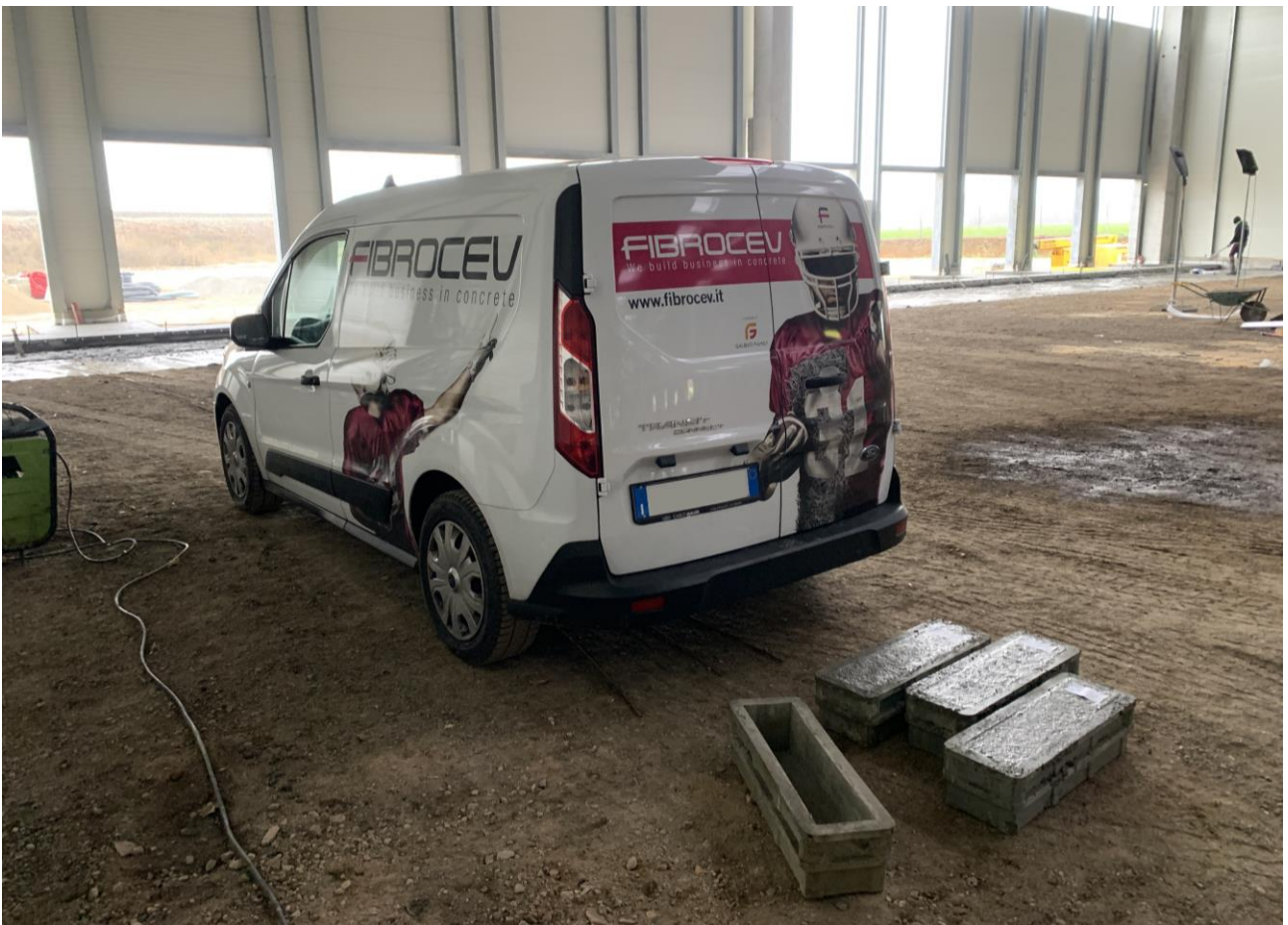
Figura 4. Prelievo di Fibrocev LAB dei campioni di FRC da sottoporre a prova di trazione per flessione secondo EN 14651
