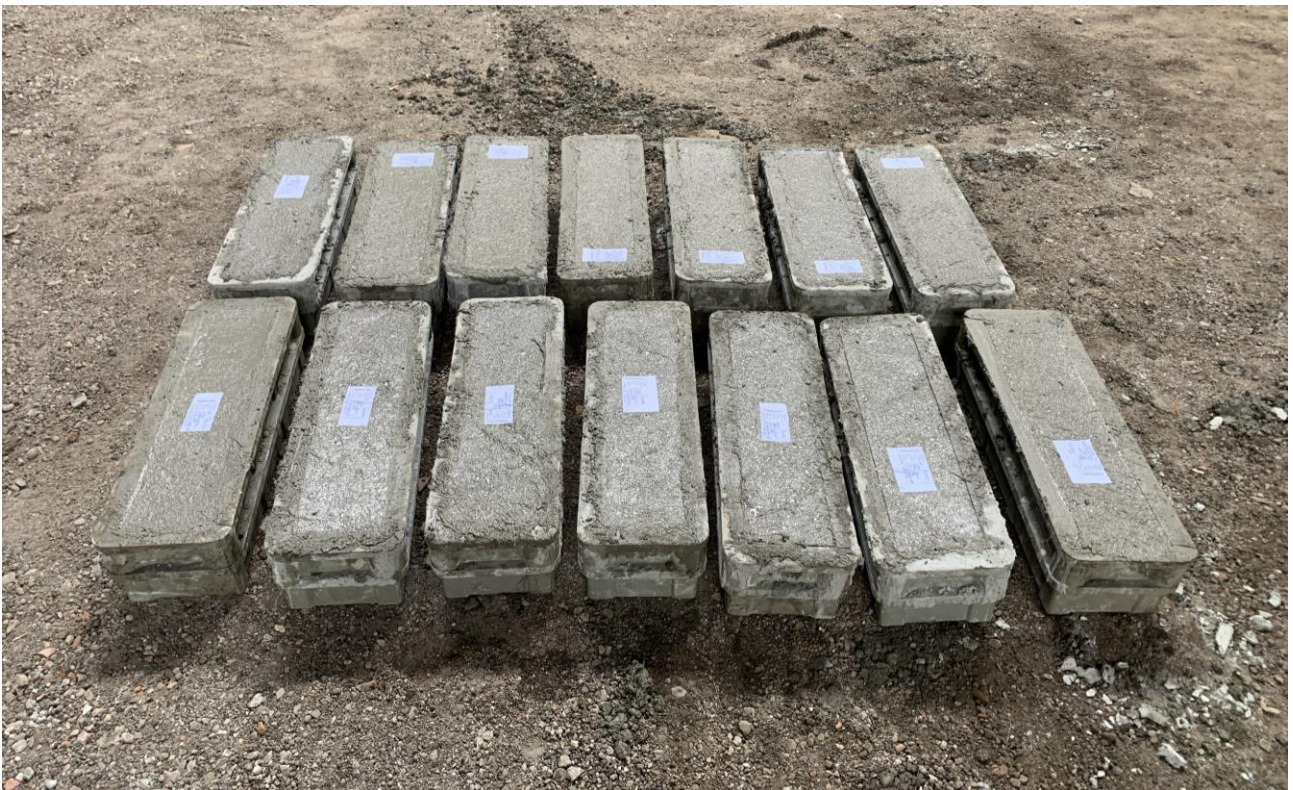
Figura 6. Prelievo dei campioni di FRC da sottoporre a prova di trazione per flessione secondo EN 14651
