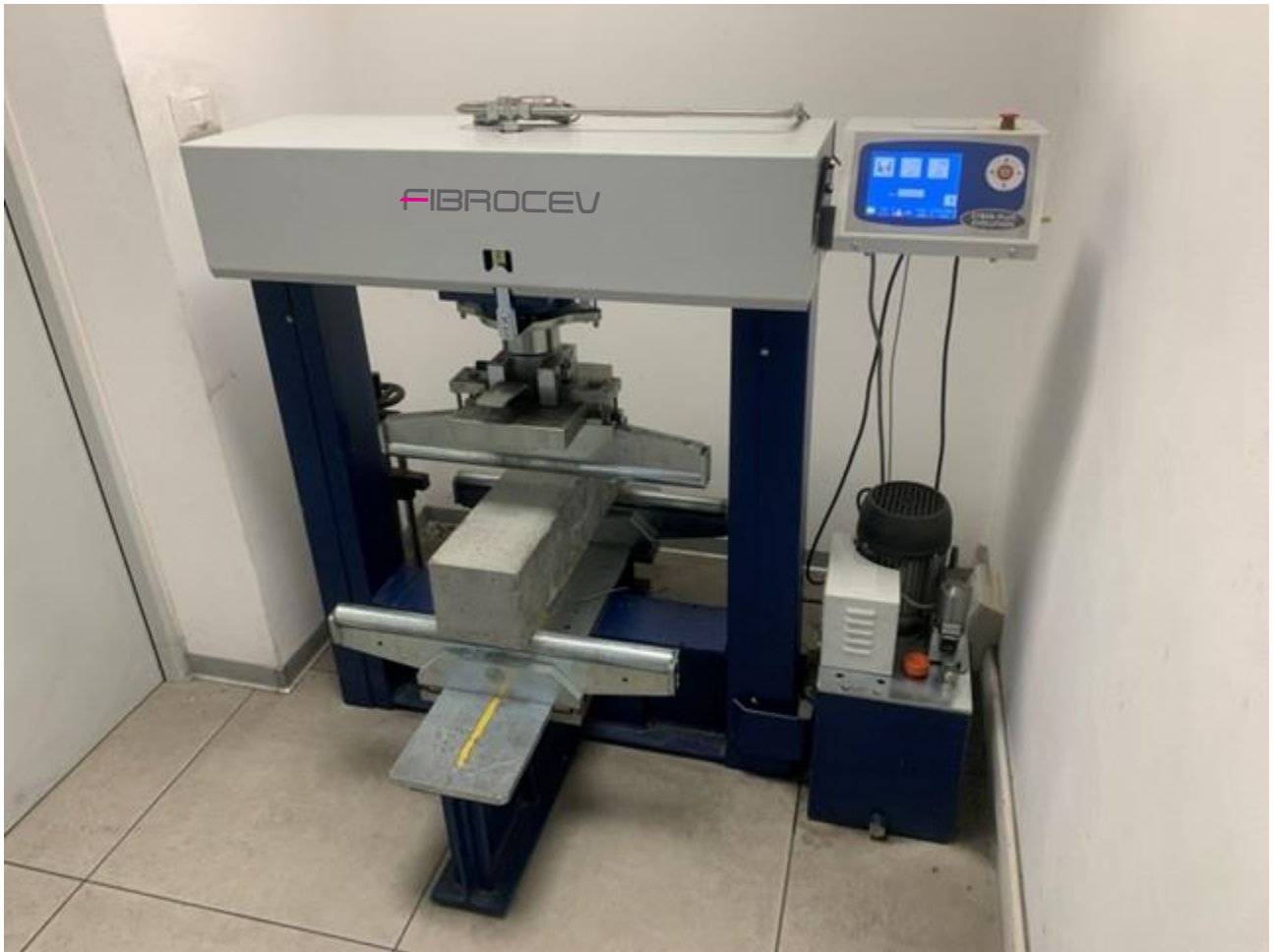
Figura 7. Set-Up prova di trazione per flessione secondo EN 14651
