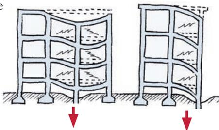
Le strutture in cemento armato hanno uno scheletro che trasmette i carichi al terreno sottostante attraverso i pilastri. Questi hanno la necessità di avere un piano di contatto più ampio con il terreno per evitare di affondare; nessuno userebbe tacchi a spillo per camminare sulla spiaggia.
