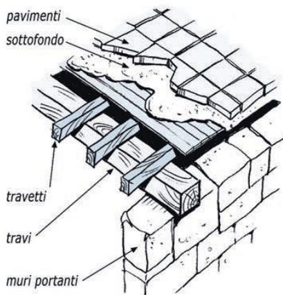
Nei vecchi edifici in muratura i solai sono per lo più in legno; talvolta sono in ferro o cemento armato e spesso sono presenti anche archi e volte. Per verificarlo fai la prova proposta a pag. 9.
