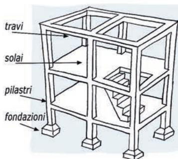
È possibile individuare lo **scheletro** degli edifici in cemento armato anche in una costruzione già completata; infatti i **pilastri** spesso sporgono dai muri divisorii e le **travi** spesso ricalano dai soffitti.
