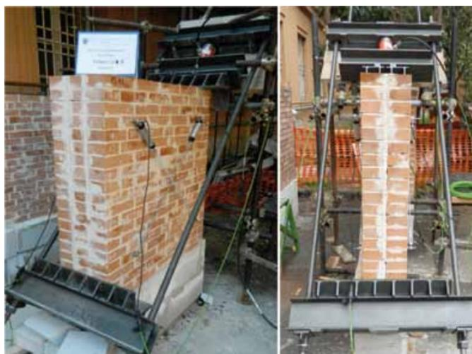
Sistema metallico allestito e pannello strumentato per l'esecuzione della prova.
