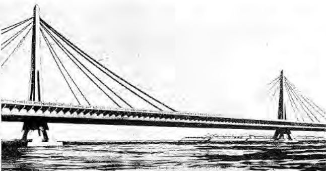
27 - Il progetto del viadotto della cornice di Jeddah in Arabia Saudita, di circa 2 Km di lunghezza totale; la campata principale di 220 m di luce; 28-29 - Il viadotto della cornice di Jeddah, particolare della pila e sezioni trasversali dell'impalcato: a) sezione tipo; b) sezione in corrispondenza delle pile principali.
