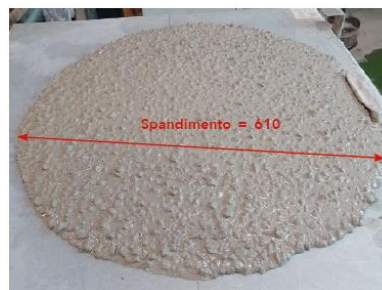
Fig. 6: calcestruzzo con bassa percentuale di parti fini con MasterMatrix LF.
