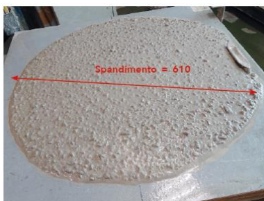
Fig. 5: calcestruzzo con bassa percentuale di parti fini senza MasterMatrix LF
