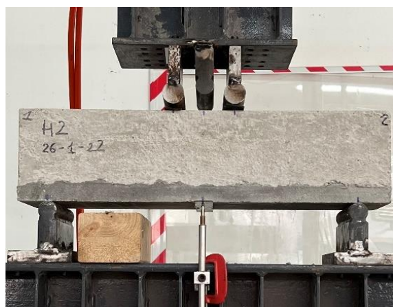
Figura 1. Provini ripristinati sottoposti a carichi dinamici. Figura 2. Rappresentazione grafica delle curve S-N delle 3 serie.
