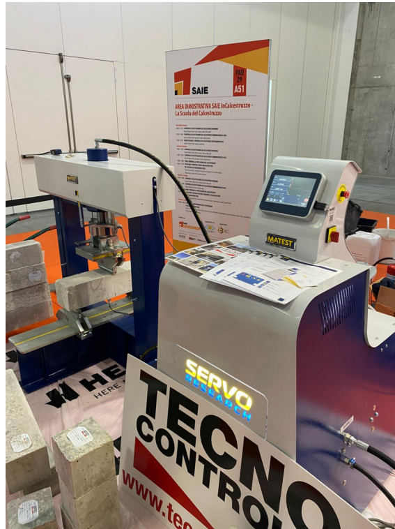
Test a flessione su tre punti di un travetto in FRC
