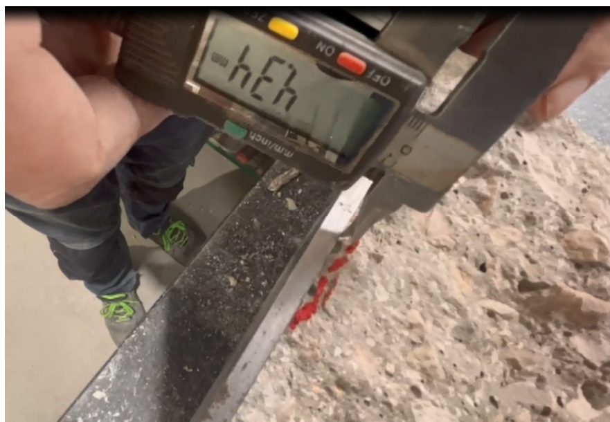
Penetrazione massima acqua sotto pressione su cubetto con cristallizzante PENETRON
