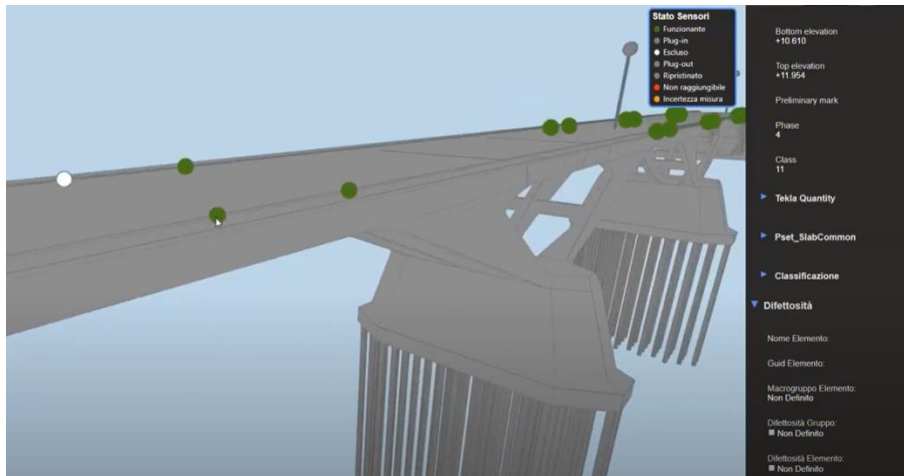
Figura 7: Visualizzazione in un Digital Twin dell'output della sensoristica applicata ad un ponte.
