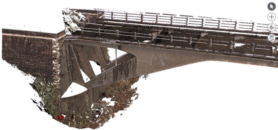
Figura 5: Nuvola di punti di un ponte ad elevato contenuto informativo.
