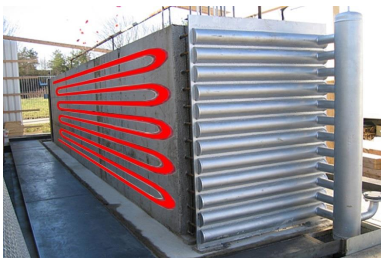
Figura 1. Schema di un modulo di accumulo di energia termica con calcestruzzo.
