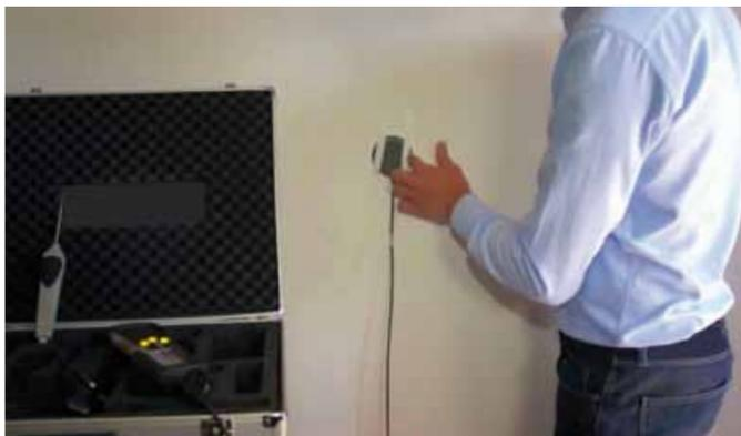
L'applicazione di una piastra flussimetrica su una parete (si noti il collegamento cablato con il data logger)
