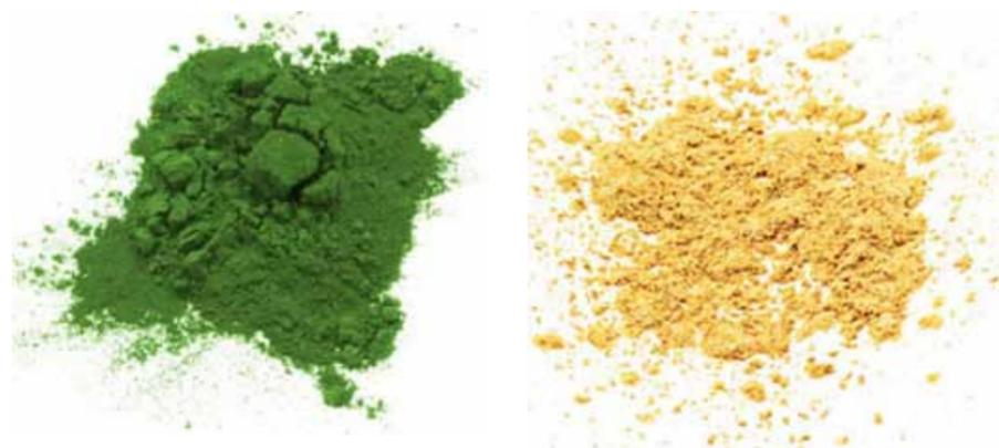
Figura 1 – Pigmenti in polvere impiegati per la colorazione delle miscele SCC
