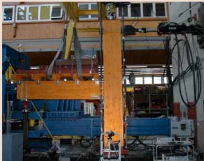
Nodo trave-colonna in scala 1:1 testato presso il Laboratorio di Strutture UNIBAS
