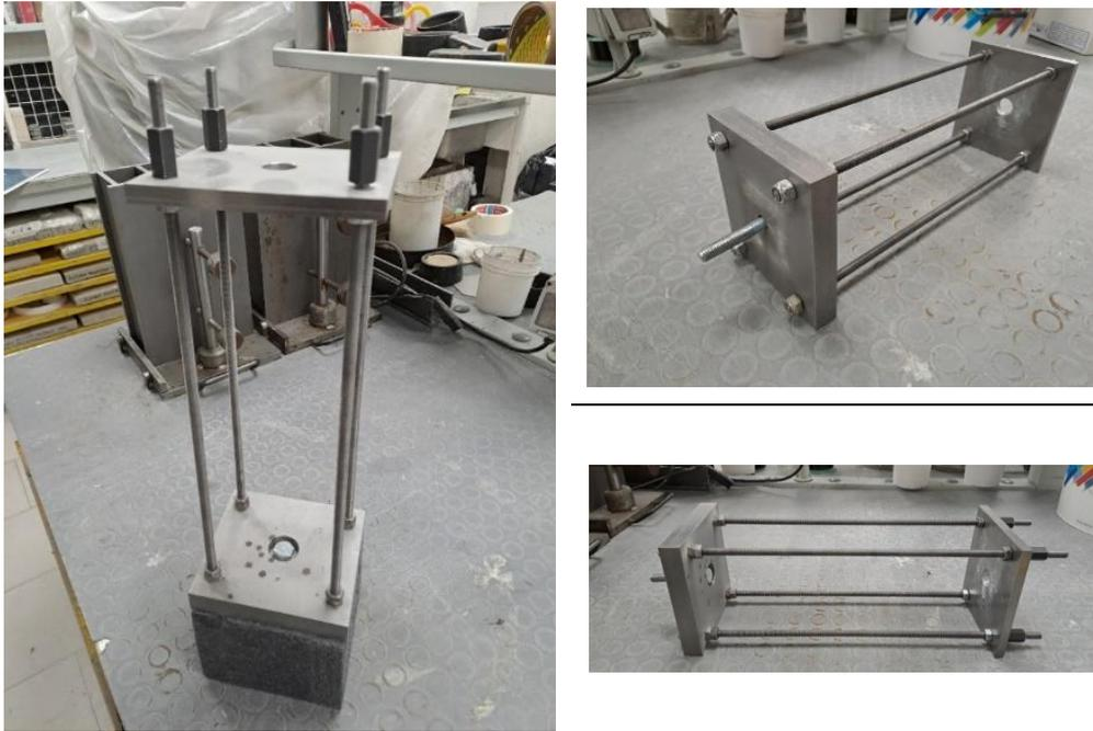
(Figura 6) - Camicia per l'afferraggio del provino
