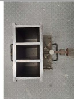
(Figura 3) – Progettazione ed esecuzione delle cubettiere
