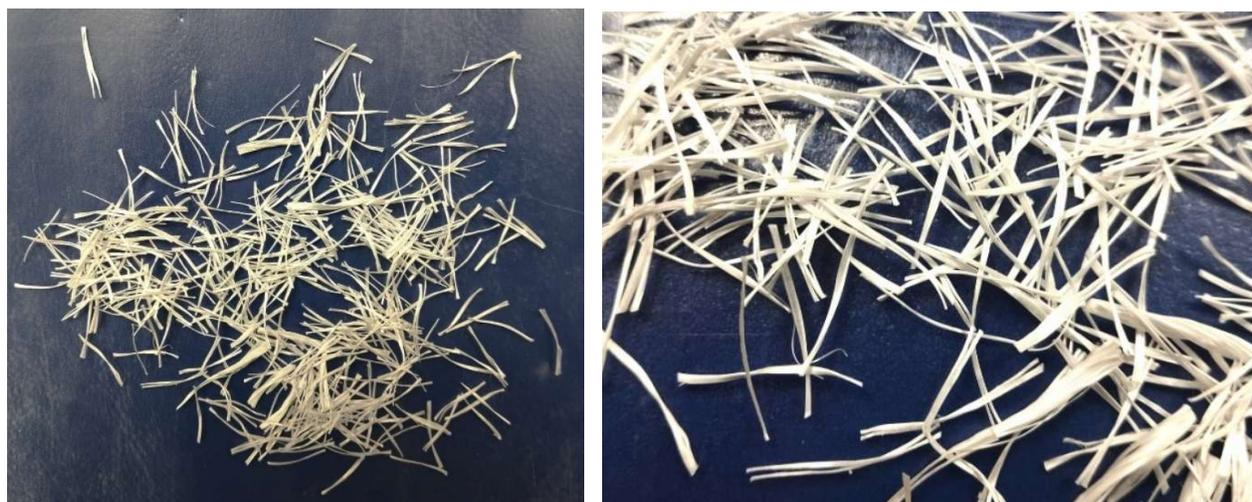
(Figura 8) – Fibre polipropileniche utilizzate nel confezionamento dei provini della Fase 2
