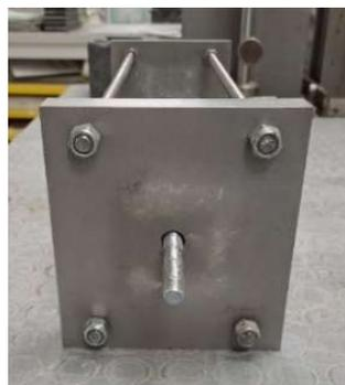
(Figura 7) - Sistema di afferraggio del provino
