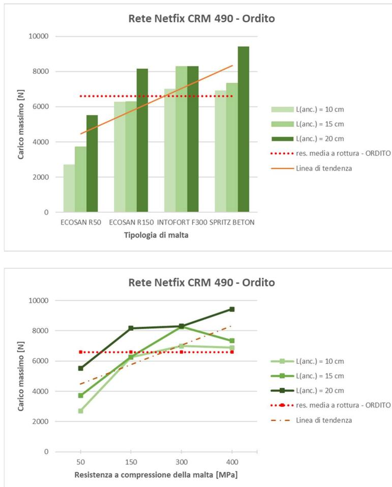
(Figura 25) – Involuppo dei valori medi delle resistenze allo sfilamento dell’“ordito” in funzione delle caratteristiche meccaniche (resistenza a compressione) delle malte testate
