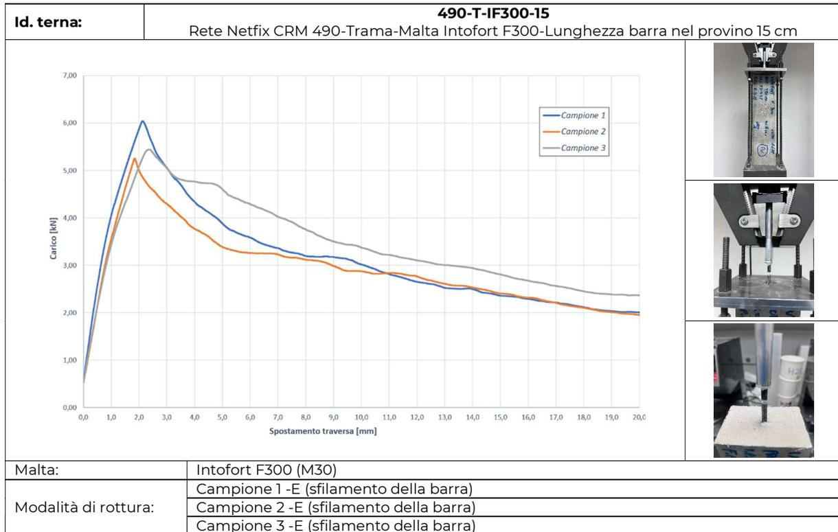
(Figura 12) – **Trama** - Risultati delle prove sulla terna “490-T-IF300-15”
