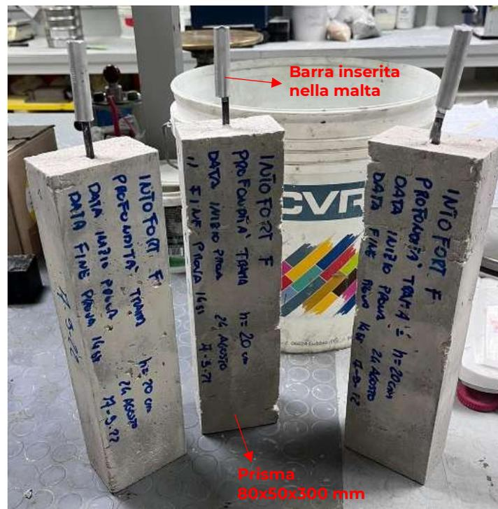
(Figura 4) – Terna di provini in attesa di prova
