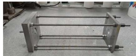
(Figura 6) - Camicia per l'afferraggio del provino
