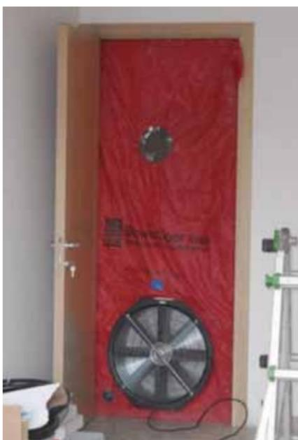
Figura 1 – Blower door test installato in un cantiere in fase di consegna
