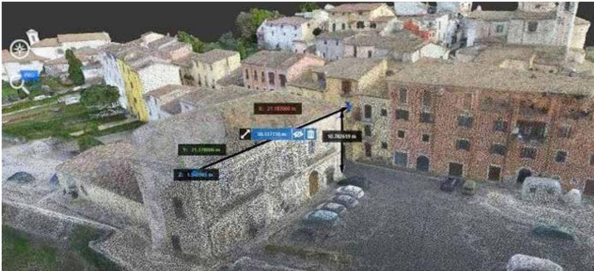
Nel presente lavoro viene presentata la valutazione della vulnerabilità sismica di due aggregati edilizi situati nel Borgo San Rocco del comune di Sora attraverso una procedura che mette in evidenza lo stretto legame tra livello di rilievo geometrico/strutturale e metodi di analisi della vulnerabilità sismica.
