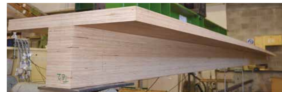
Figura 1 – Solaio composto in microlamellare di faggio
