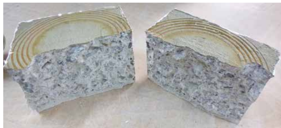
Foto 1 – Provino rotto a compressione per valutare la penetrazione all'acqua dopo la prova di impermeabilità
