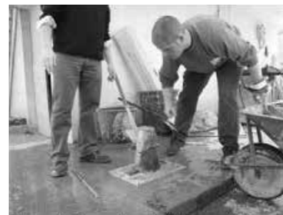
Figura 1: Riempimento del cono di Abrams
