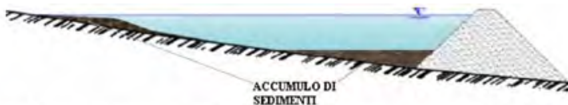
Fig. 2 – Rappresentazione schematica dell'accumulo di sedimenti in un invaso visto in sezione longitudinale
