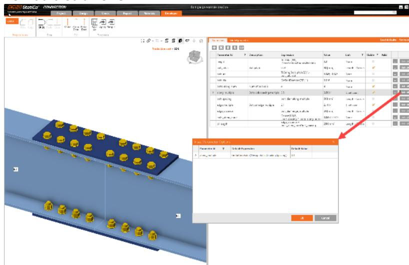
Con la nuova funzione dei gruppi di progettazione creati dall'utente in Checkbot, un progetto può essere applicato istantaneamente a più connessioni. L'applicazione riconosce anche le tipologie e le disposizioni, riducendo la necessità di inserimento manuale.
