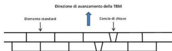
Figura 4. Tipica disposizione dei conci rettangolari e trapezoidali
