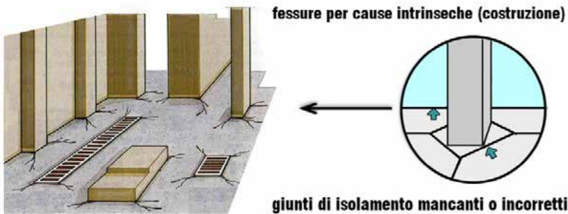
meno, di presidi (giunti di isolamento), sia nelle connessioni fra strutture orizzontali e verticali che in corrispondenza di irregolarità geometriche (chiusini, basamenti, ecc.). I giunti di isolamento debbono infatti essere previsti ovunque il pavimento in calcestruzzo sia collegato a strutture verticali ed a contorno di pilastri, chiusini, basamenti ed irregolarità geometriche di qualsiasi natura.
