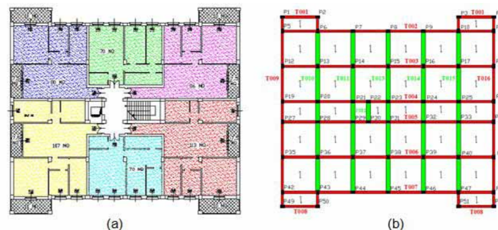
Figura1. “Piano tipo” dell'edificio analizzato come caso di studio: (a) planimetria; (b) pianta strutturale.
