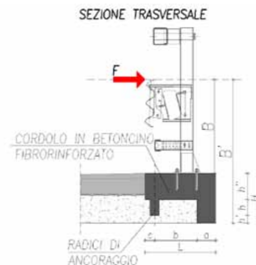
Figura 1. Geometria generica dei cordoli fibrorinforzati
