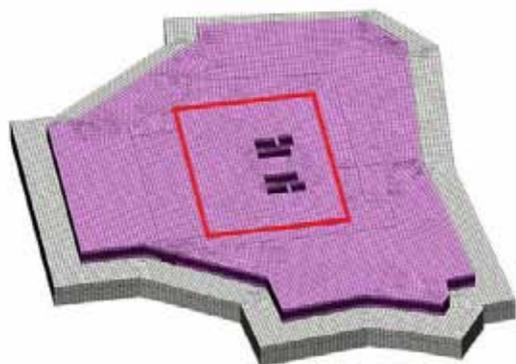
**Figura 3.** Video 3D del getto fondazionale con evidenziata nella parte centrale quella con altezza 3 metri
