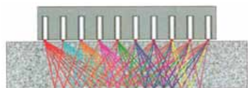
Figura 7. Il procedimento di cui alla figura 6, è ripetuto per ciascun sensore della medesima riga eccettuato l'ultimo. La figura illustra i vari percorsi ultrasonori che sono così generati. Se i sensori nella riga sono, ad esempio, 10, il numero totale di percorsi ultrasonori generati sarà: 9+8+7+6+5+4+3+2+1=45 . Il processo di emissione-ricezione fin qui illustrato viene ripetuto
