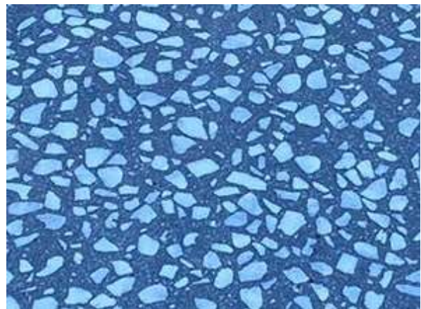
Figura 9 – Dettaglio dell'aspetto finale di una pavimentazione esterna realizzata con malta STRUCTURE PAV MF4-S integrata con aggregati bianchi selezionati.
