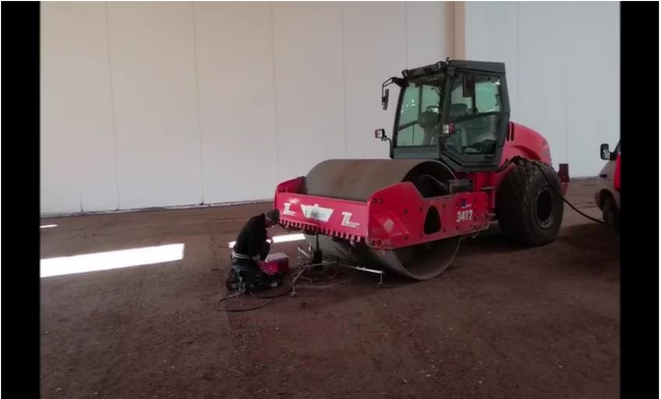
Figura 4. Prove di piastra sul sottofondo
