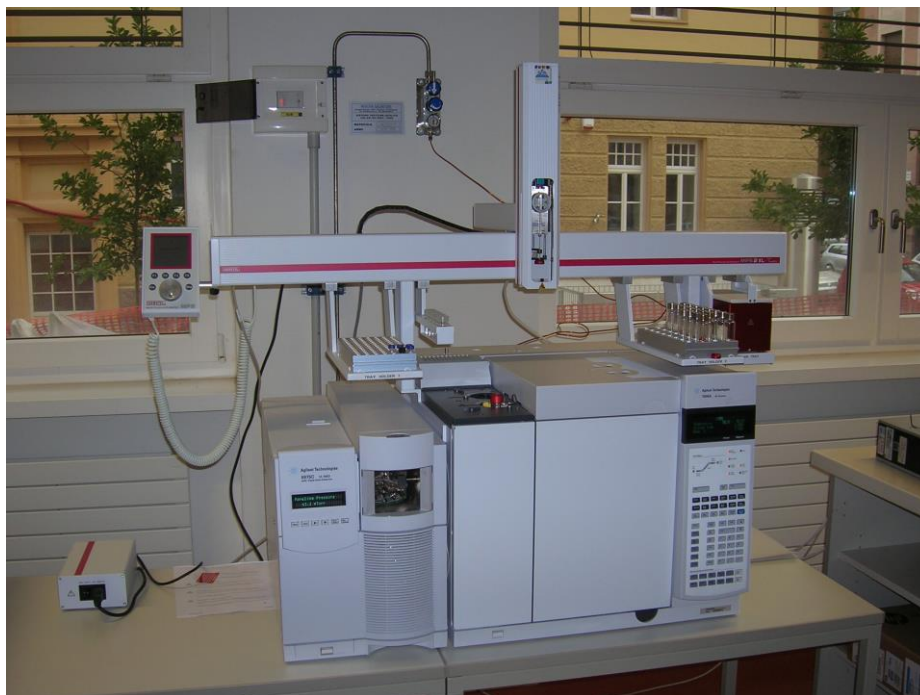
Figura 1 – Gascromatografo con spettrometro di massa (GC-SM)
