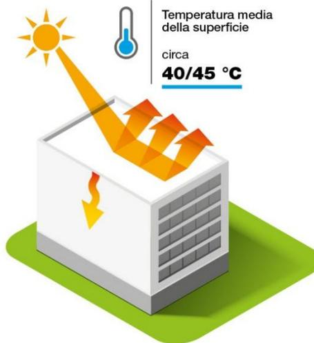
Le [pitture ad alta riflettività](#) Copernit creano una barriera ad alta remissività e riflettività dei raggi solari, vantano un SRI elevatissimo e riducono drasticamente la temperatura superficiale del manto impermeabile rispetto alle vernici tradizionali.
