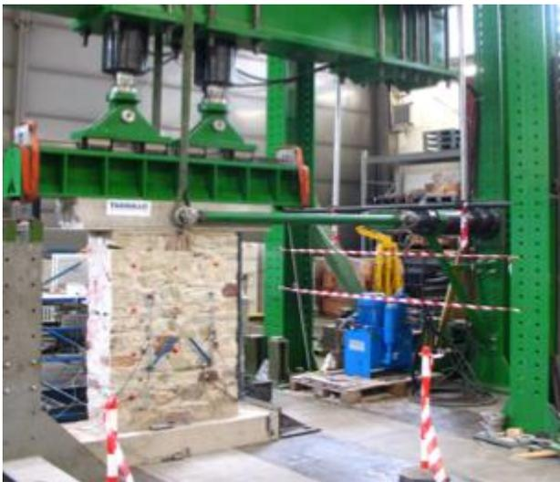
Interventi di iniezione di miscele a base di calce idraulica naturale, ristilatura e inserimento di tirantini trasversali in muratura di pietrame
