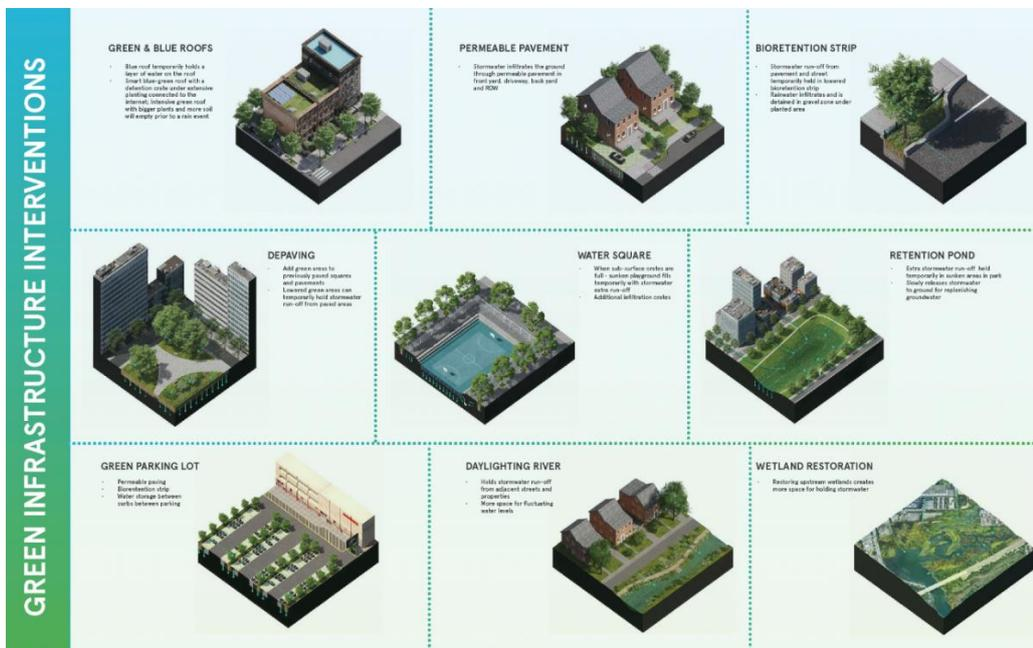
**Figura 1 - Abaco degli interventi con infrastrutture verdi (credits, Towards a Rainproof NYC; 2022; Rebuild by Design e One Architecture & Urbanism). Lo schema va letto in senso orario, a partire dalla prima immagine in alto a sinistra.**
