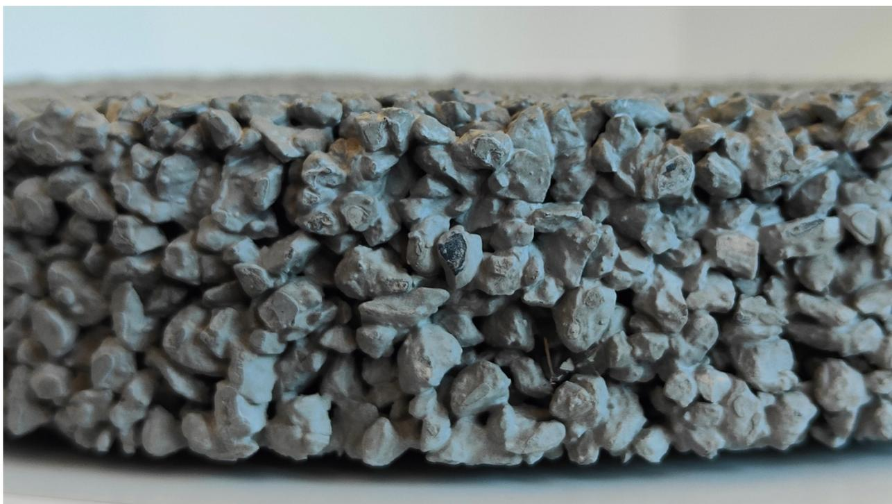
*Particolare di conglomerato cementizio drenante realizzato con Bravo Drain Admix*
