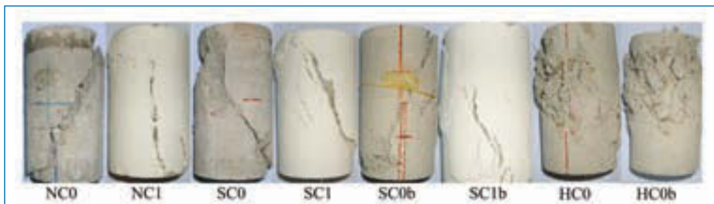
Fig. 4 - La rottura a compressione nei provini esaminati.
