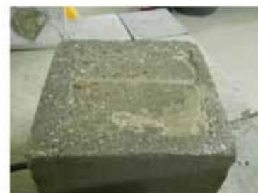
Rimozione dell'eccesso di Penetron mediante fresatura
