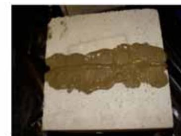
Riempimento fessura con Penetron Standard
