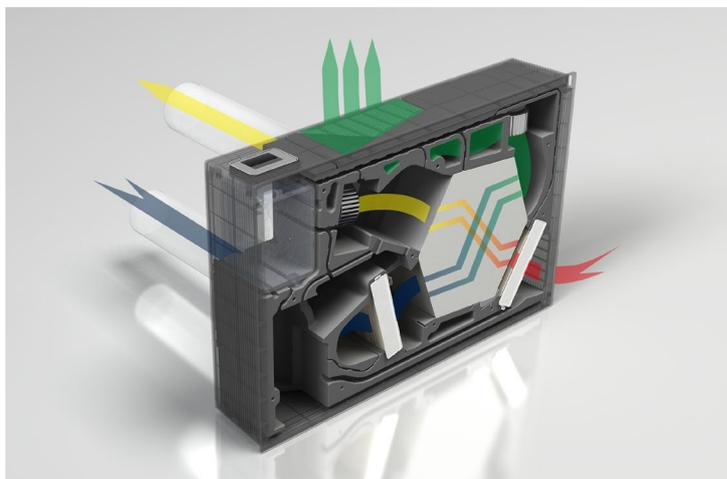
I filtri **ISO ePM1** e **ISO Coarse** garantiscono la pulizia dell'aria, mentre lo scambiatore di calore a flussi incrociati, disponibile in versione sensibile o entalpica, riduce i consumi energetici recuperando oltre il 90% dell'energia termica dell'aria espulsa.
