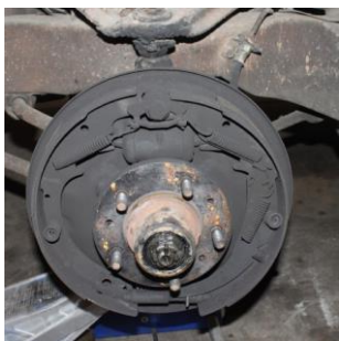
Figura 12, 13 – Esempi di usi di amianto nell'industria dei trasporti. Da sinistra: ferodi di freni per veicoli, guarnizioni di caldaie
